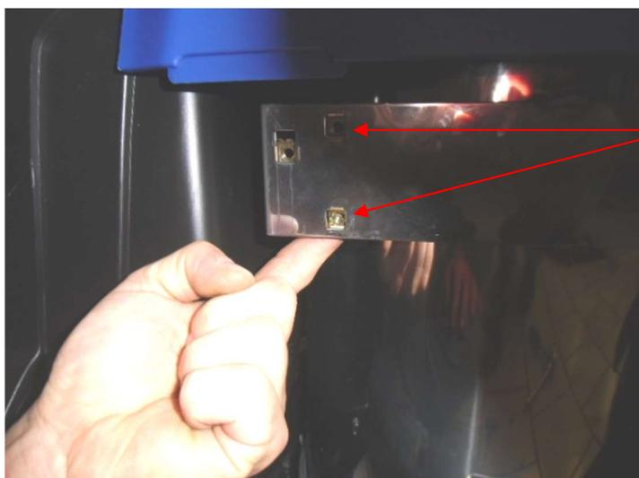
Insertion de 4 écrous cage fournis dans le kit enrouleur de tuyau (N ° 2 par côté)
